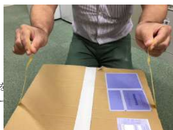
①ダンボールを組み、PP バンドを 180 cm ほどでカットし、ダンボール下に通す。
