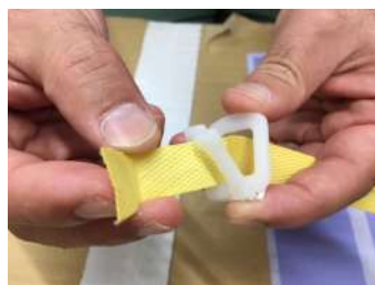
②留具の脚を折り、PP バンドの片方を脚の間から通す。
